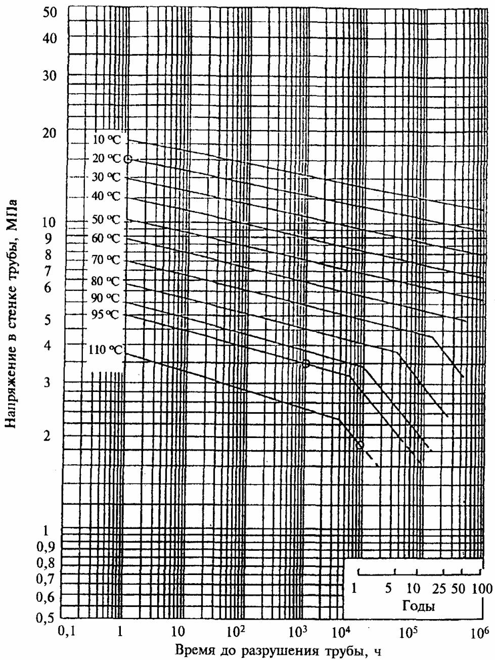
Левая часть ломаной:  $\lg(t) = -55,725 - 9484,1 \lg(\sigma)/T + 25502,2/T + 6,39 \lg(\sigma)$
