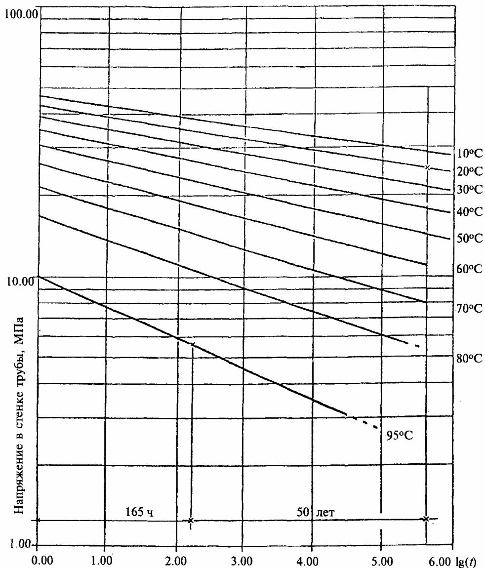
$$\lg(t) = -109,95 - (21897,4/T) \lg(\sigma) + 43702,87/T + 50,74202 \lg(\sigma),$$
