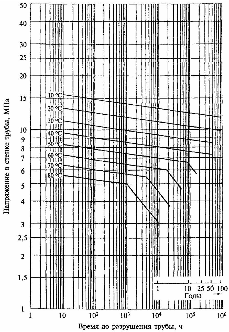
Левая часть ломаной:  $\lg(t) = -38,9375 + 24482,4670/T - 38,9789 \lg(\sigma)$
