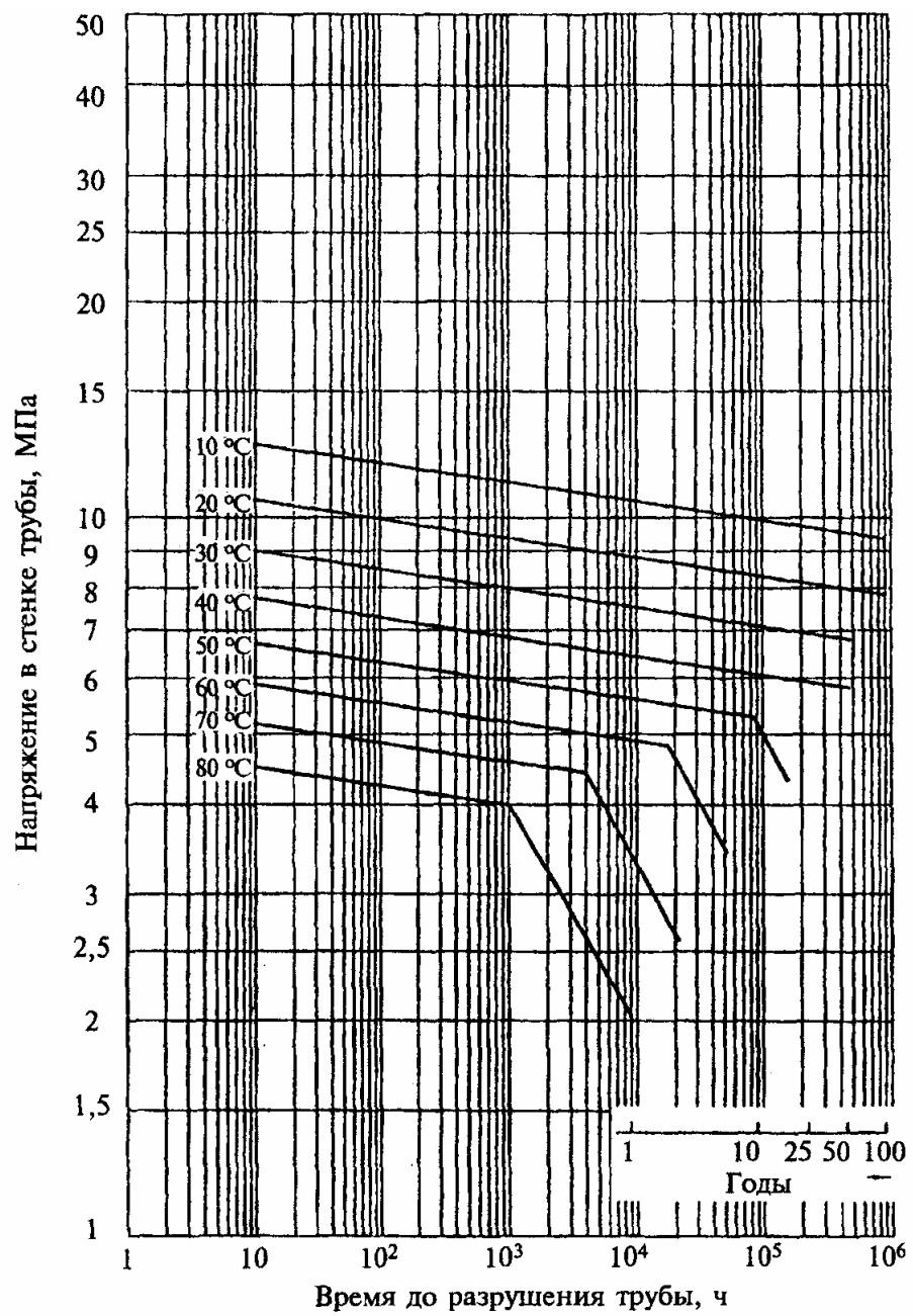
Левая часть ломаной:  $\lg(t) = -40,9578 + 23596,3495/T - 37,5758 \lg(\sigma)$
