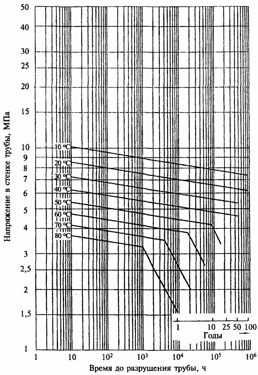
Левая часть ломаной:  $\lg(t) = -41,4173 + 22008,5722/T - 35,0987 \lg(\sigma)$
