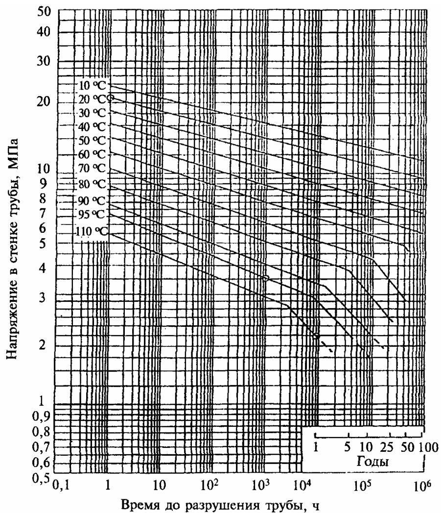
Левая часть ломаной:  $\lg(t) = -46,364 - (9601,1/T) \lg(\sigma) + 20381,5/T + 15,24 \lg(\sigma)$
