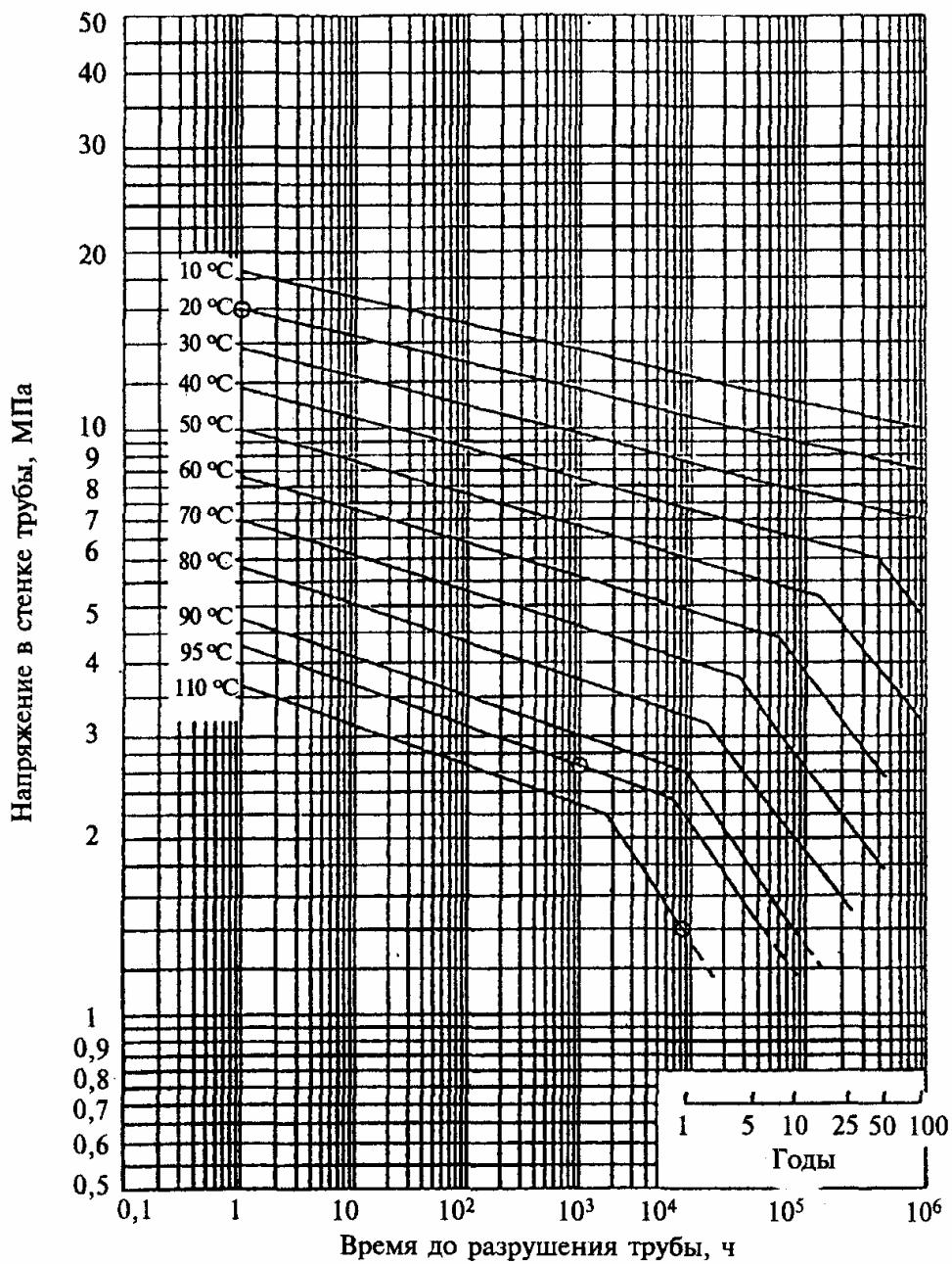
Левая часть ломаной:  $\lg(t) = -56,086 - (10157,8/T) \lg(\sigma) + 23971,7/T + 13,32 \lg(\sigma)$
