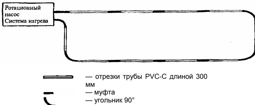
**Рисунок 2** — Схема испытаний kleевых соединений труб и фитингов из PVC-C на стойкость к аварийной температуре  $T_{\text{авар}}$
