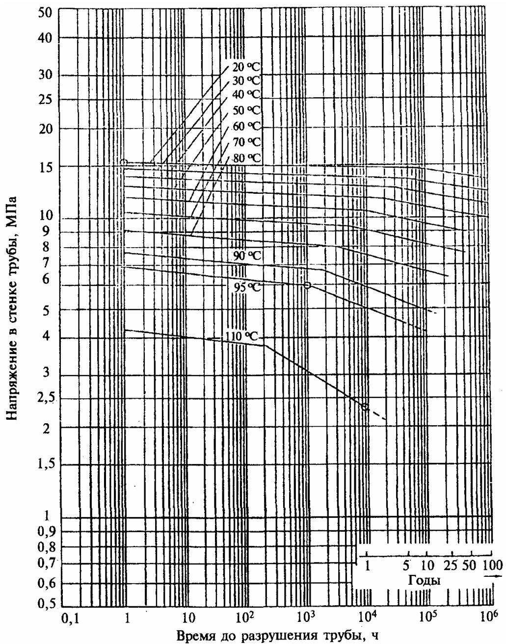
Левая часть ломаной:  $\lg(t) = -430,866 - (125010/T) \lg(\sigma) + 173892,7/T + 290,0569 \lg(\sigma)$
