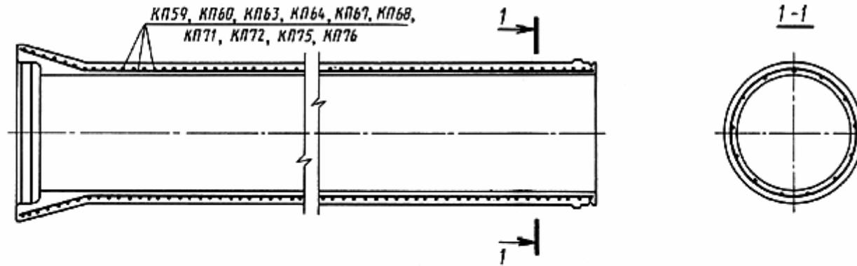
Деталь армирования стенки трубы
