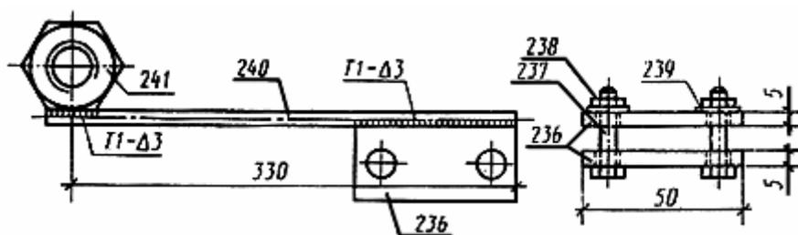
Пример установки закладного изделия М1 в трубах типа ТБ
