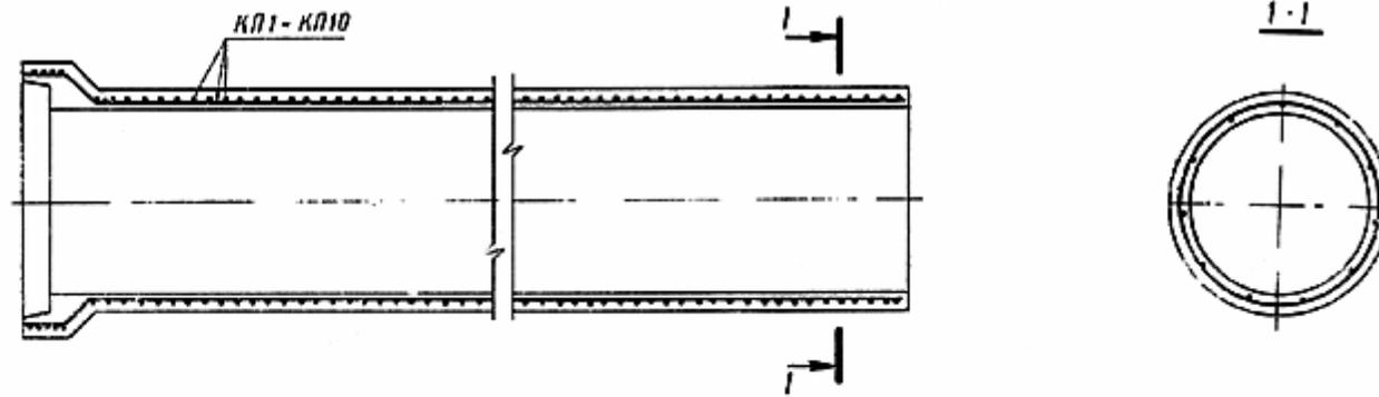
Деталь армирования стенки трубы
