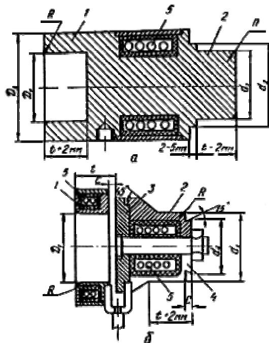
Рис.8. Инструмент для раструбной (а) и раструбно-стыковой (б) сварки:
