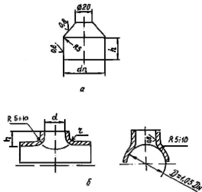
Рис.5. Основные размеры оснастки для вытяжки горловин:
