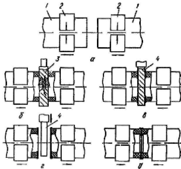
Рис.6. Схема контактной сварки встык:
