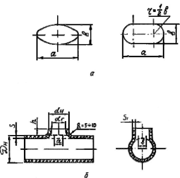
Рис.4. Форма и основные размеры отверстий и вытянутой горловины:
