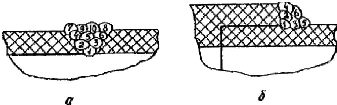
Рис.10. Схема укладки прутков в шов:
