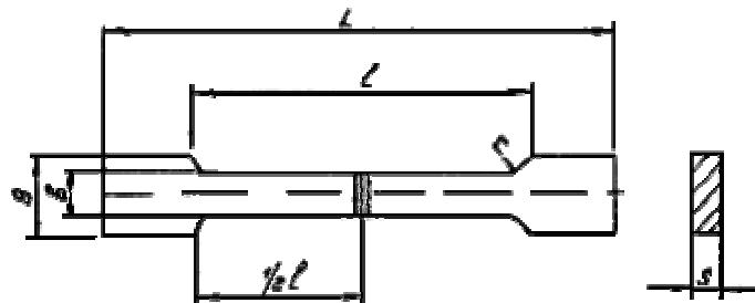
Рис.14. Образец для испытания стыковых соединений на растяжение
