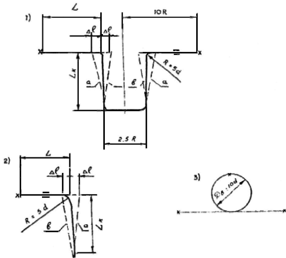
Рис.7. Устройство компенсаторов
