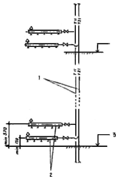
Рис.5. Вариант подсоединения распределительных коллекторов к стоякам из стальных труб:
