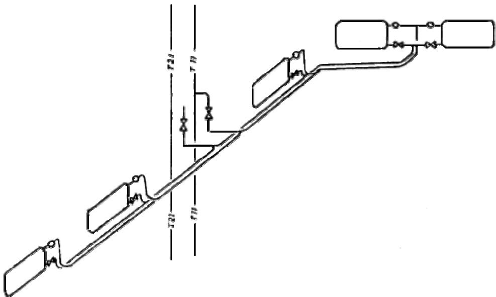
Рис.1. Система отопления с горизонтальными двухтрубными ветками для группы параллельно-последовательно соединенных отопительных приборов
