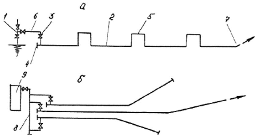
Рис.6. Принципиальная схема продувки промыслового трубопровода:
