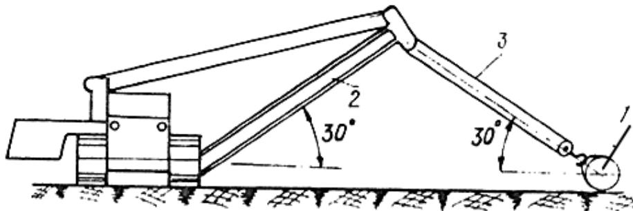
Рис.19. Схема фиксации продувочного патрубка трубоукладчиком:
