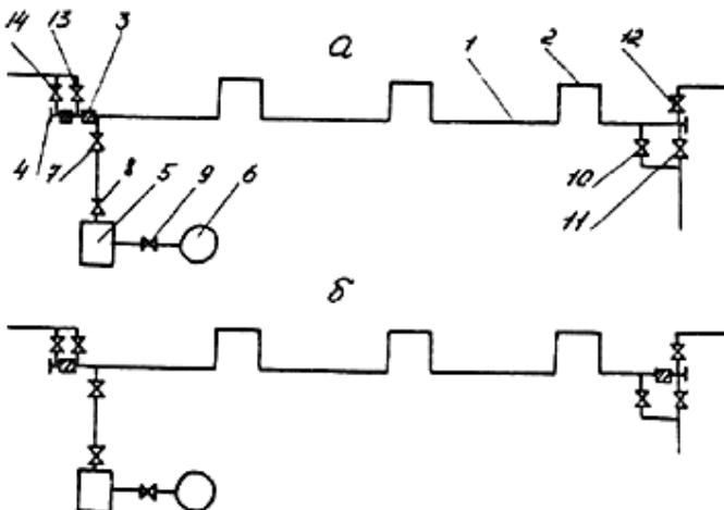
Рис.14. Принципиальная схема испытания трубопровода подогретой водой:
