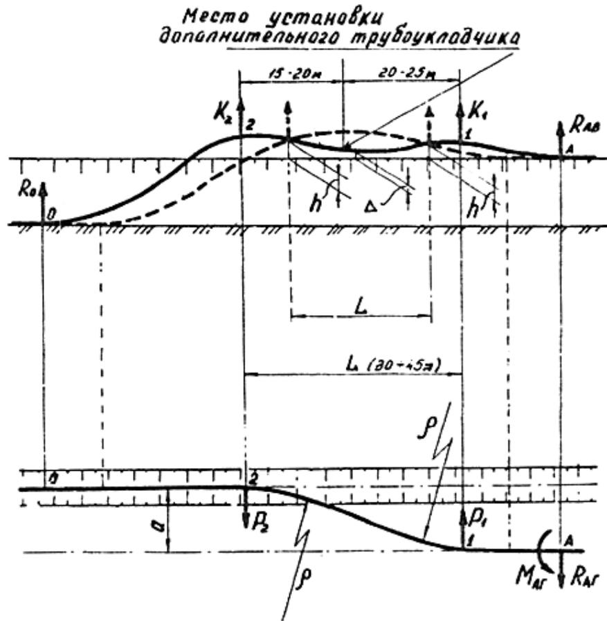
Расчетно-технологическая схема к обоснованию выбора числа трубоукладчиков при укладке трубопроводов
