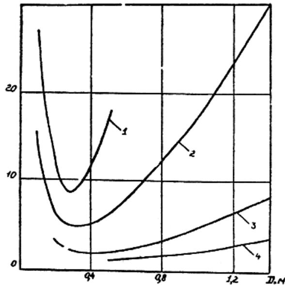
Рис. 2. Зависимость времени прокачки воды с температурой  $T_g^* = 50^\circ\text{C}$  для эталонного трубопровода от его диаметра при суммарной производительности наполнительных агрегатов
