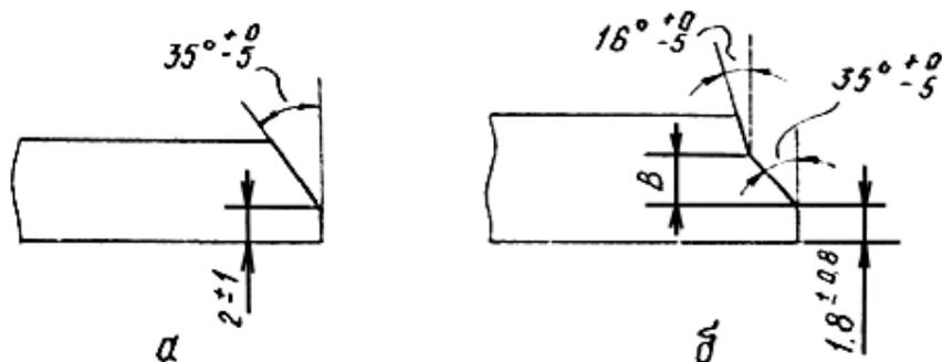
Рис. 1. Формы подготовленных кромок:
