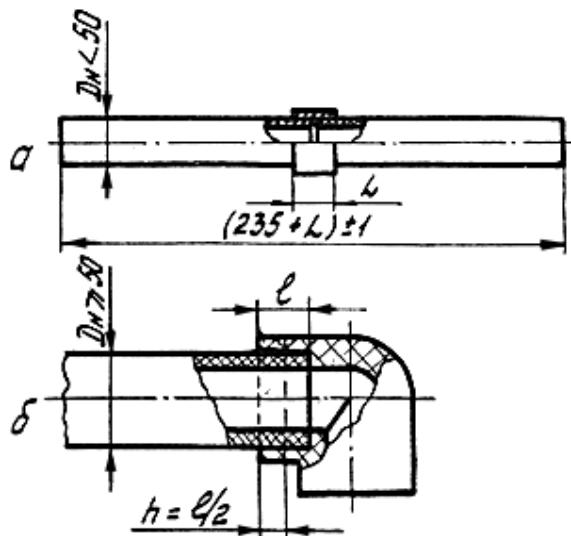
Рис. 2. Образцы для испытаний сварных раструбных соединений:
