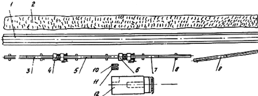
Рис. 13. Схема организации сварочного поста при сварке трубопровода в непрерывную нитку с двумя центраторами:
