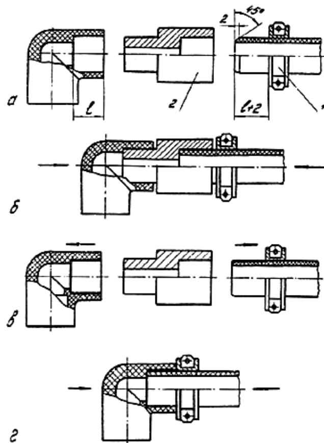
Рис. 9. Последовательность процесса контактной сварки враструб туб и соединительных деталей из ПВД:
