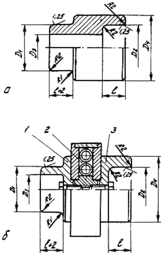
Рис. 10. Схема нагревательного инструмента для раструбно-стыковой сварки:
